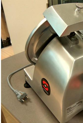
Antes de comenzar a limpiar, asegúrese de que la Cortadora esté apagada y desconectada de la fuente de alimentación.
