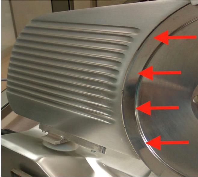
Posicione la placa completamente cerrada (perilla índice en posición cero), frote y limpie la mesa comenzando en la cuchilla y tirando hacia usted. ¡Nunca haga lo contrario! Siempre recuerde secar.
