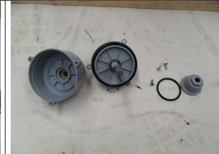
**5- Soltar los 3 tornillos para poder abrir la carcasa del pistón.**
