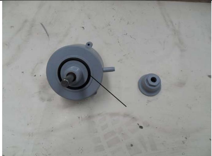
**13- Volver a atar la tapa con los 3 tornillos y colocar la junta torica en su canal.**
