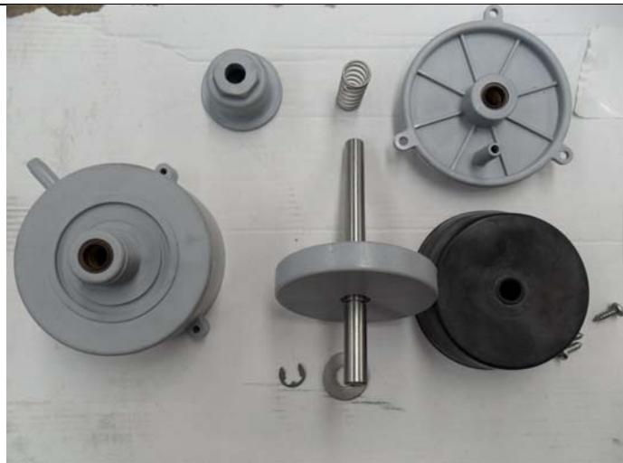
**6- Quitar las carcasas del pistón hasta quedar solo la membrana con el eje.**
