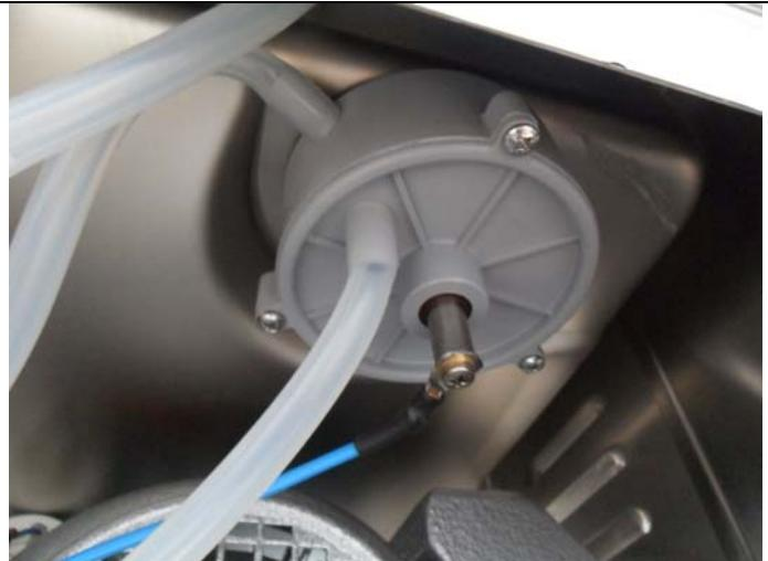
**14- Colocar los tubos y conectar el cable de corriente.**
