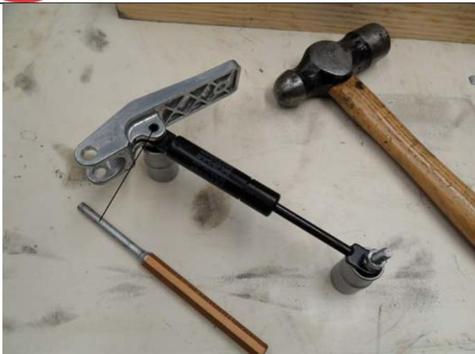
**6- Sacar el pasador elástico usando un botador de 6mm.**
