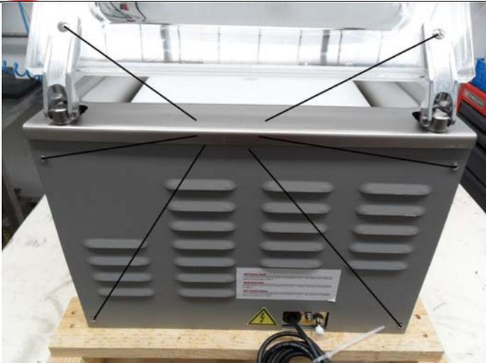
**10- Por último colocar la campana con cuidado fijándolo con los 2 tornillos y atar la tapa trasera con los 4 tornillos.**
